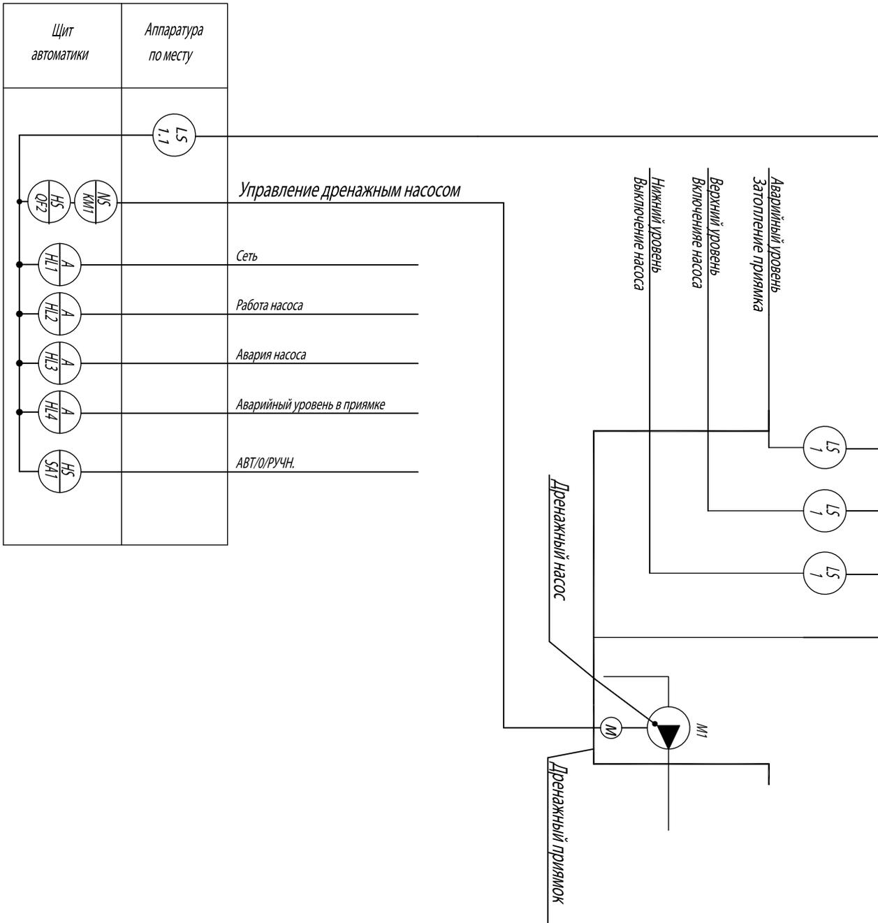
Схема соединений внешних проводов
